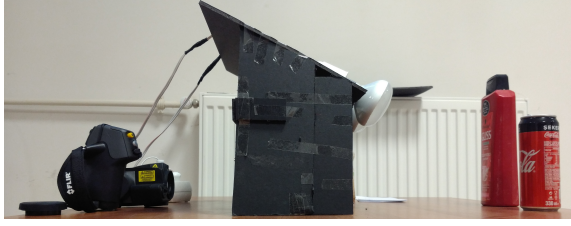
Şekil 1. Isı lambaları ve termal kameradan oluşan sistemimizin kurgusu.
